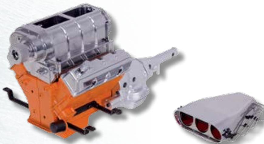
◀ На иллюстрации — двигатель с присоединенными впускным коллектором и компрессором. Отдельно расположен воздухозаборник с присоединенными к нему форсунками и трубками.
