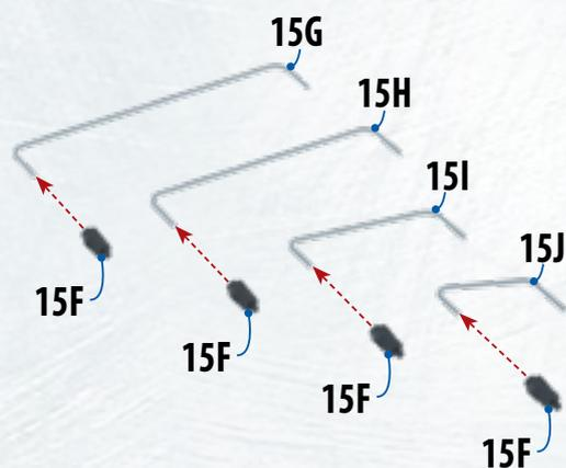
**15.8** СОЕДИНИТЕ ФОРСУНКИ 15F с трубками 15G, 15H, 15I и 15J. Для этого вставьте в форсунки более короткие концы трубок. Чтобы облегчить себе дальнейшую работу, рассортируйте трубки по размеру. ◀
