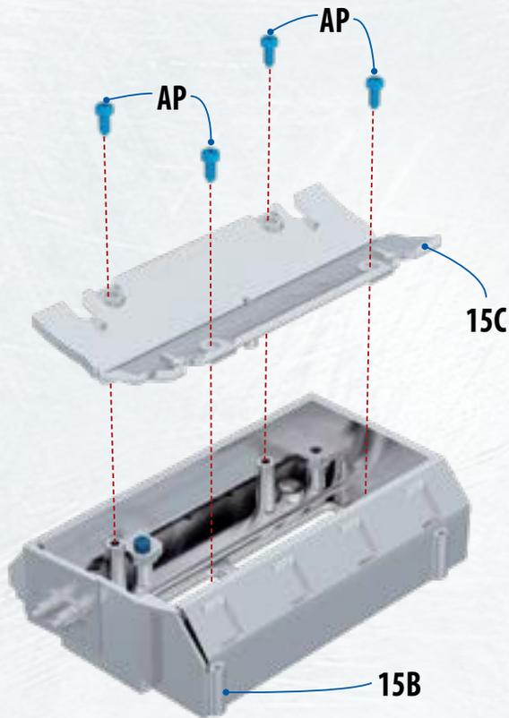
**15.2** **СОВМЕСТИТЕ ДЕТАЛЬ 15С** с конструкцией, собранной в предыдущем шаге так, как показано на фотографии (их крепежные отверстия должны при этом совпасть), а затем зафиксируйте ее четырьмя винтами АР. ◀
